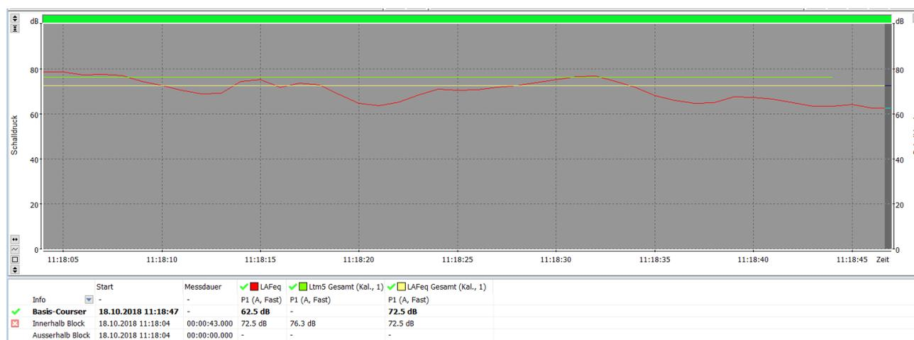
Abbildung 6: Pegelzeitverlauf des Schalldruckpegels beim „Messerschärfen“ eines Claas Häckslers in 14 m Abstand vom Fahrzeug
